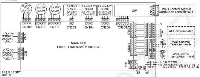
STM : Stepper Motor Moteur à engrenages LS : Limit Switch Interrupteur de fin de course SW : Switch PCB Circuit imprimé du commutateur
